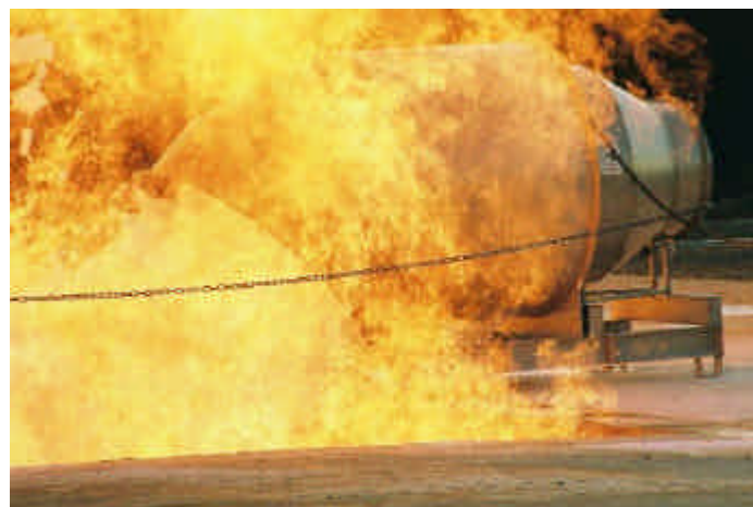
Angus LNG Turbex applies Expandol high expansion foam despite searing heat of LNG fire
